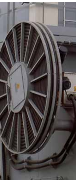
Tamburo monospira doppio , con due cavi identici dalla sezione trasversale ampia.
